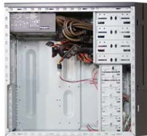
Lange Kabel und Platz für bis zu 11 Laufwerke im Innenbereich
