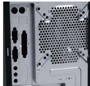
Vorne und hinten lassen sich 80, 92 oder 120 mm Lüfter einsetzen
